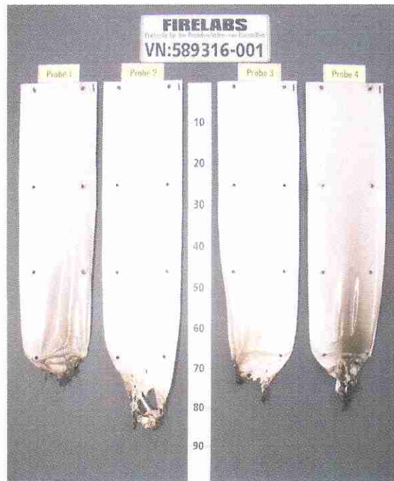
Bild 2 Aussehen des Probekörpers nach dem Brandversuch
